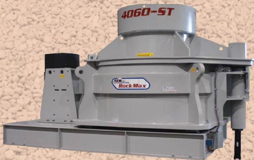
Se ha comprobado que la trituración de impacto VSI es el método más eficiente para la reducción de rocas, minerales de hierro y otros minerales. Esto se debe a que es la mejor manera de transferir la energía de los motores de transmisión al material que se está reduciendo. Las trituradoras de impacto tienen menos partes móviles y menor pérdida mecánica en comparación con las máquinas de compresión, como las trituradoras de cono.
