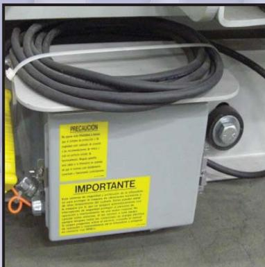
**REMco** trituradoras son pre-cableado para interruptores de enclavamiento, protección contra vibraciones y cumplimiento de la seguridad.
