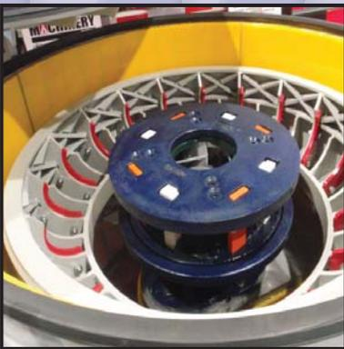
Insertos de cámara de trituración autógenos removibles con celdas profundas y refuerzos protectores ajustables.
