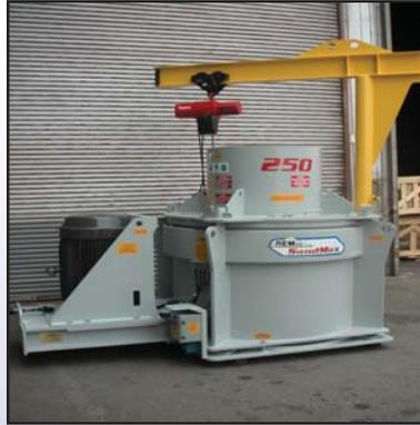
La grúa de servicio opcional de **REMco** puede equiparse con ensambles de levaje eléctricos o manuales.
