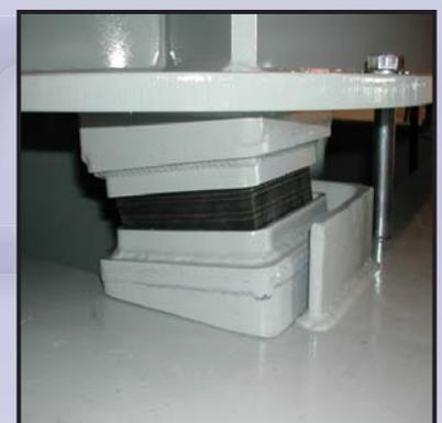
Cuatro montajes de aislamiento de vibración de centrado automático para una suave operación y para proteger los motores de transmisión y el equipo circundante.
