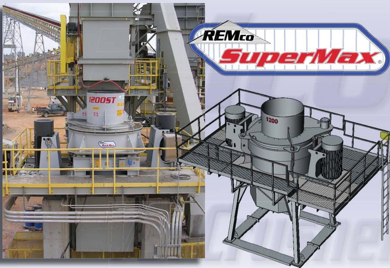
Los modelos **SuperMax** vienen equipados con todos los accesorios normales, como lubricación de aceite, rotores de repuesto, equipos de instalación y sistemas de **REMco SmartBox**. Además, las **SuperMax** pueden incluir cualquier número de características especiales o únicas que el cliente solicite. La **SuperMax** generalmente se utiliza en aplicaciones de tercera o cuarta etapa de trituración cuando se requieren grandes cantidades de producción.
