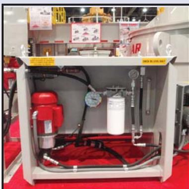
Aceite de lubricación con depósito y sensores de seguridad; incluyendo calefacción y enfriamiento del aceite lubricante.
